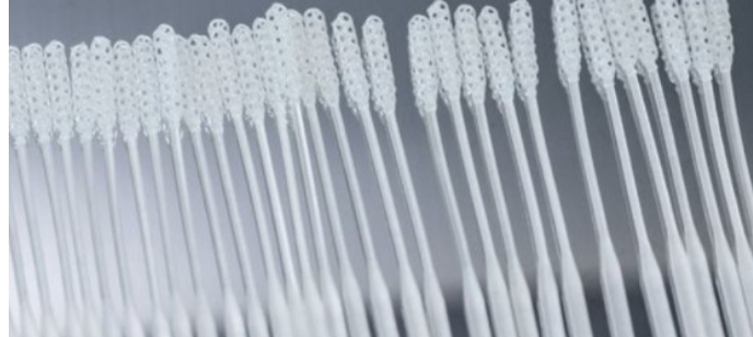
Abb. 22: Fertig gedruckte Stäbchen (Quelle: Henkel AG & Co. KGaA)
