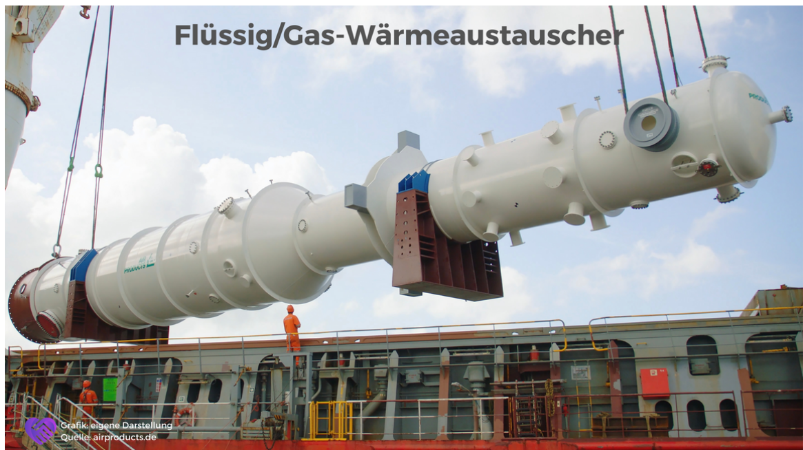
Abb. 7: Ein Flüssig/Gas-Wärmeaustauscher von Air Products wird auf ein Frachtschiff geladen und an den Kunden verschickt.
